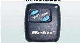
Радиопередатчик и приемник предназначены для дистанционного запуска и останова электростанции.
