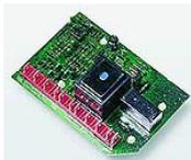
Устройство, контролирующее состояние изоляции между ИТ-сетью и защитным проводом на соответствие нормам VDE 0100 части 410 с аварийной индикацией.
