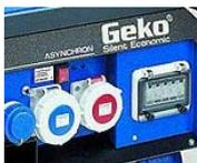
Дополнительное защитное устройство, контролирующее утечку тока, с силовым автоматическим выключателем и аварийной индикацией. Применяется в основном в области газового и водного хозяйства.
